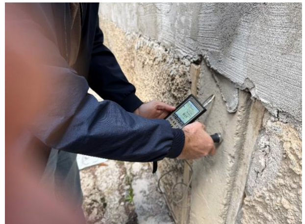
Նկ. 11 Շենքի երկաթբետոնե կոնստրուկցիաների բետոնի փաստացի ամրության որոշման դրվագներ «Օնիկս-2.6» գործիքի միջոցով
