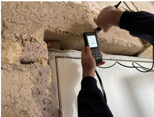
Նկ. 11 Շենքի երկաթբետոնե կոնստրուկցիաների բետոնի փաստացի ամրության որոշման դրվագներ «Օնիկս-2.6» գործիքի միջոցով
